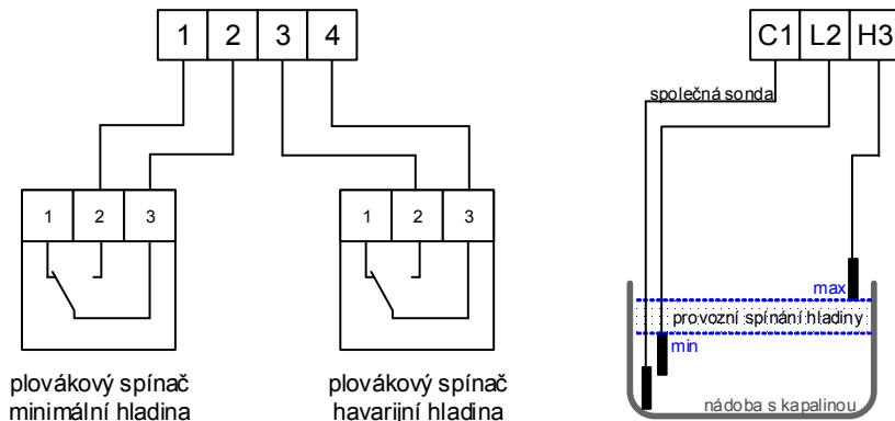
Měřící sondy se připojí na svorky C1,L2 a H3, plovákové spínače se připojují ke svorkám 1 až 4, měděnými vodiči podle výše uvedeného obrázku. Plovákový spínač pro minimální hladinu ke svorkám 1 a 2, plovákový spínač pro havarijní hladinu ke svorkám 3 a 4. Slaněné vodiče je třeba ukončit dutinkami.
