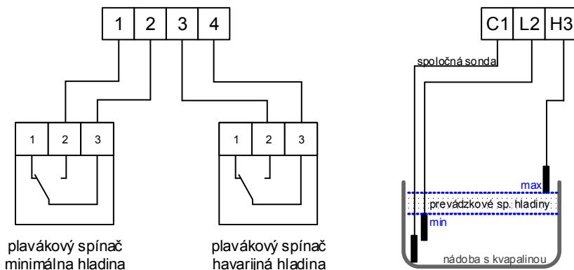
Meracie sondy sa pripoja na svorky C1, L2 a H3, plavákové spínače sa pripájajú k svorkám 1 až 4, medenými vodičmi podľa vyššie uvedeného obrázka. Plavákový spínač pre minimálnu hladinu k svorkám 1 a 2, plavákový spínač pre havarijnú hladinu k svorkám 3 a 4. Lankové vodiče je potrebné ukončiť dutinkami.
